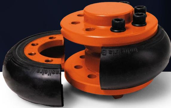
Os acoplamentos Acriflex AX Bipartido são compostos por dois cubos simétricos de Ferro Fundido Nodular, um elemento elástico bipartido vulcanizado de borracha natural de elevada elasticidade, flexibilidade e resiliência. Troca rápida do elemento elástico sem necessidade de mover os equipamentos, mesmo com espaçamento pequeno entre ponta de eixos.
