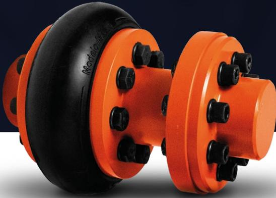
Os acoplamentos AX com Espaçador são compostos por dois cubos simétricos de Ferro Fundido Nodular, um espaçador em Ferro Fundido Nodular e um elemento elástico vulcanizado de borracha natural de elevada elasticidade, flexibilidade e resiliência.
